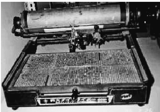
図1 杉本京太の発明した邦文タイプライター1号機*
