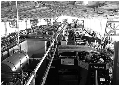
写真16 ロボット自動搾乳機（手前）を設置した近代的な畜舎 （2018年8月筆者撮影）
